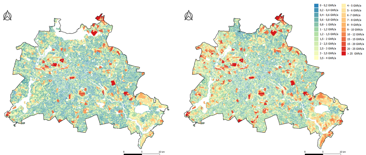
Abbildung 33: Theoretisches Potenzial des ISU5-Blocks für eine Tiefe von 100m (aktueller Stand der Genehmigungspraxis in Berlin, links) und für die maximal mögliche Tiefe (Rupeltonoberkantentiefe oder 400m, rechts), Heizfall.
